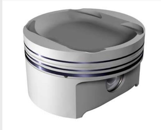
Ein Unterscheidungsmerkmal der Kolben vom Saug- bzw. Turbomotor sind die Verbrennungsmulden. Diese sind beim Turbokolben, um die Verdichtung zu reduzieren, wesentlich tiefer ausgelegt.
