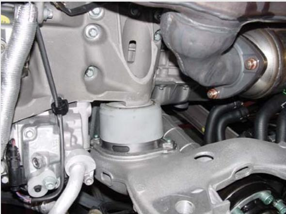
Die hohen Motordrehmomente der V8-Motoren werden über eine zusätzliche Drehmomentstütze am Zylinderkopf aufgenommen.
