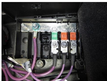
Изображение. Распределительный блок 48 В
