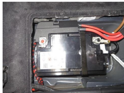
Рис. Расположение аккумулятора в автомобиле с левым рулем.
