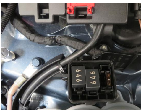
Изображение реле для пускового реле и блок предохранителей диагностики пусковых реле
