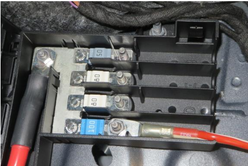
Изображение. Распределительная коробка предохранителей в пространстве для ног переднего пассажира
