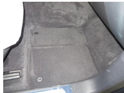
Рис. Крышка отсека для аккумулятора в автомобиле с левым рулем.
