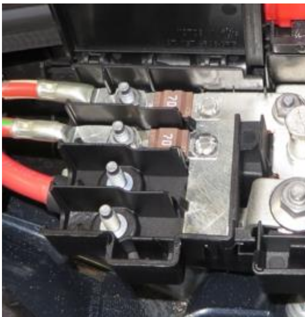
Точка подключения внешнего источника питания с плюсовым штифтом и центральной защитой моторного отсека
