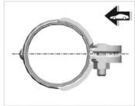
Klemmschellenposition beim Festziehen waagrecht
