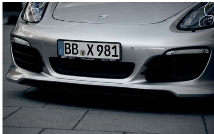
Der zweiteilige Frontspoiler mit integriertem Splitter fügt sich nahtlos in die Designlinie ein. The two-part front spoiler with integrated splitter flows perfectly into the front apron design.
