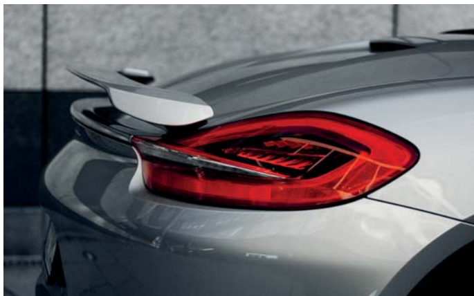
Aus dem Windkanal: der TECHART Heckflügel mit feststehendem Flügelprofil. Wind-tunnel tested: the TECHART rear wing with fixed-wing profile.
