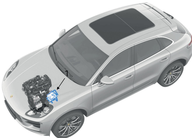
Положение блока управления DME
