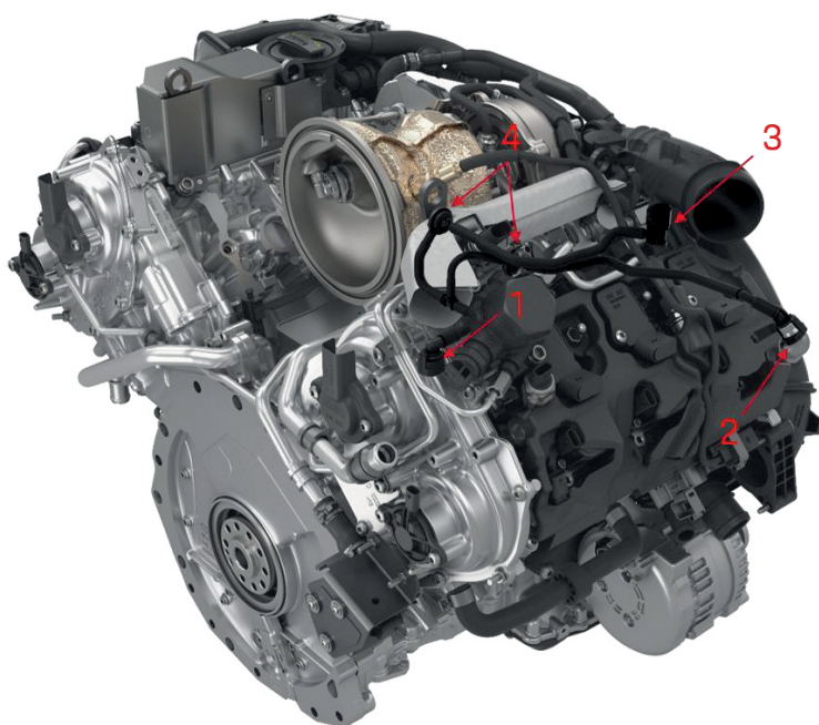
Система вентиляции картера
