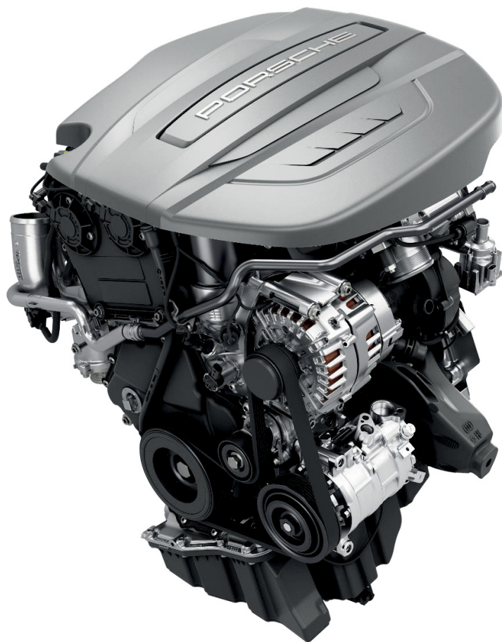
2,0-литровый рядный 4-цилиндровый двигатель
