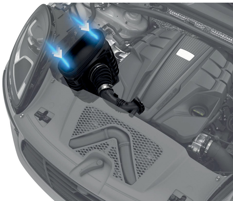
Впуск неотфильтрованного воздуха
