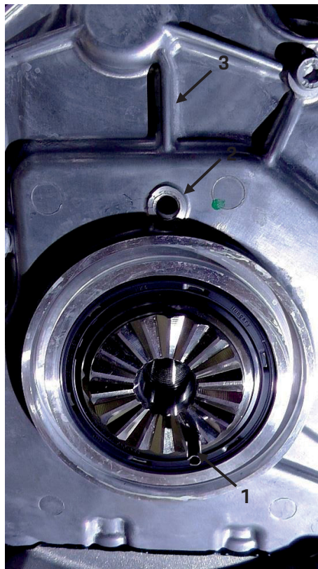
Конец коленчатого вала с хиртовым зацеплением и установочным штифтом
