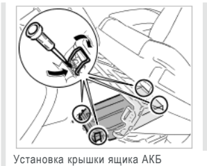
Установка крышки ящика АКБ
