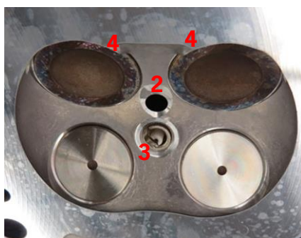
Расположение форсунки и конструкция камеры сгорания
