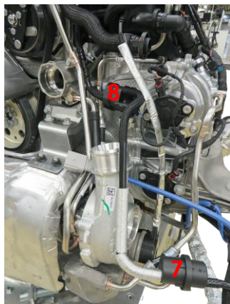
Топливопровод низкого давления
