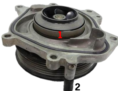
Насос ОЖ закрыт
