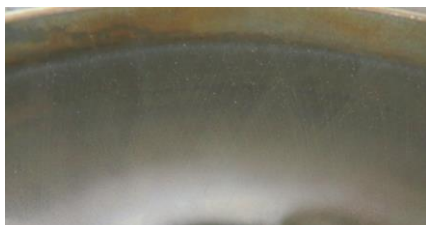
Рабочая поверхность цилиндра после хонингования
