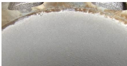
Рабочая поверхность цилиндра с покрытием по технологии PTWA (перед хонингованием)
