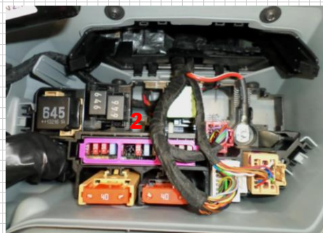
Блок реле / предохранители в коммутационном блоке
