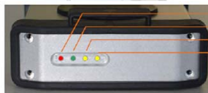
1 - Светодиод состояния 3 - Светодиод USB 2 - Светодиод питания 4 - Светодиод WLAN
