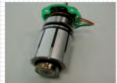
Ротор с четырьмя парами постоянных магнитов
