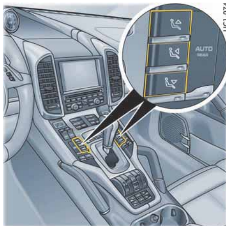
Кнопки распределения воздуха на передней панели
