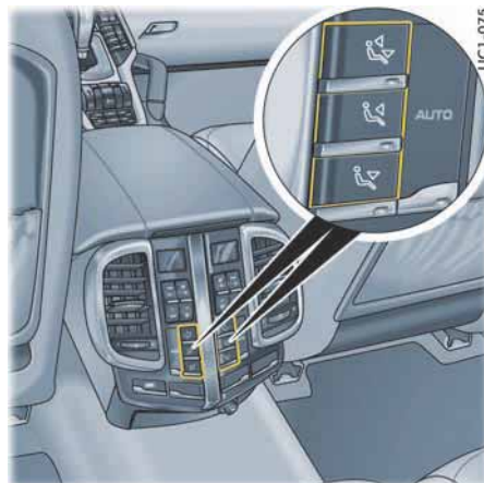
Кнопки распределения воздуха на задней панели (четырёхзонный кондиционер)
