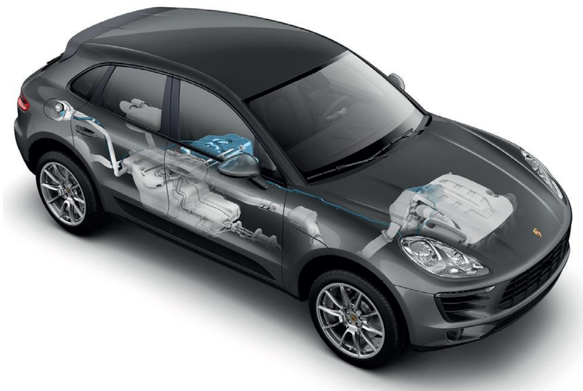
Сажевый фильтр и бак для AdBlue® на модели Macan S Diesel
