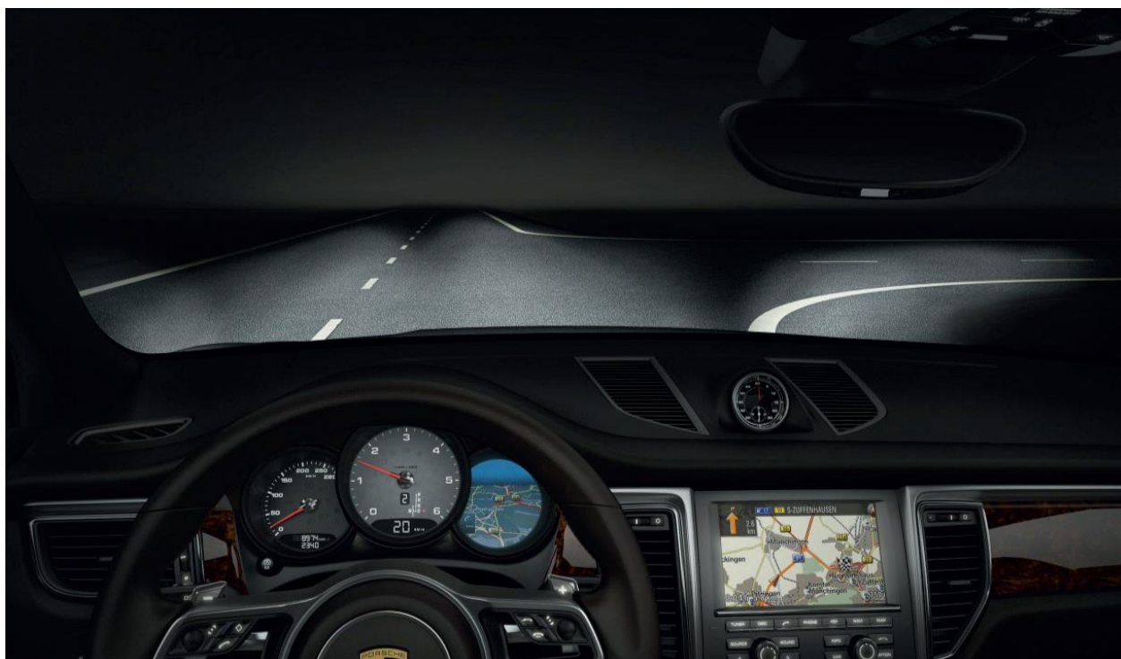
Функция освещения на перекрестках (составная часть системы PDLS Plus)
