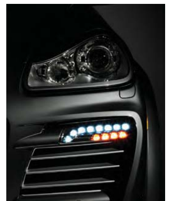
Dimmung des Tagfahrlichts beim Abbiegen Dimmed DRL during turning maneuver
