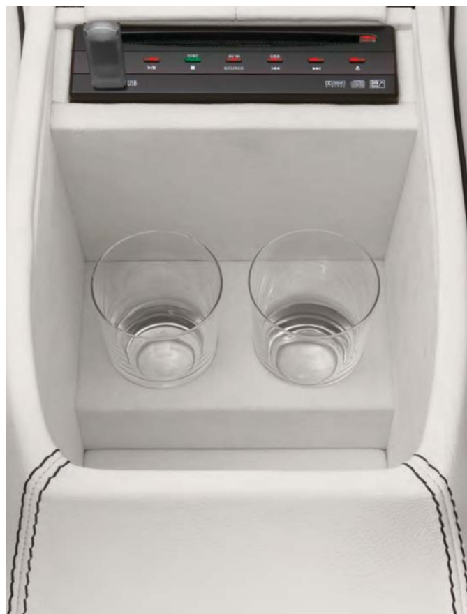
DVD-/Medioplayer mit integriertem USB-Host in der Fondmittelkonsole DVD/media player with integrated USB host in the rear center console
