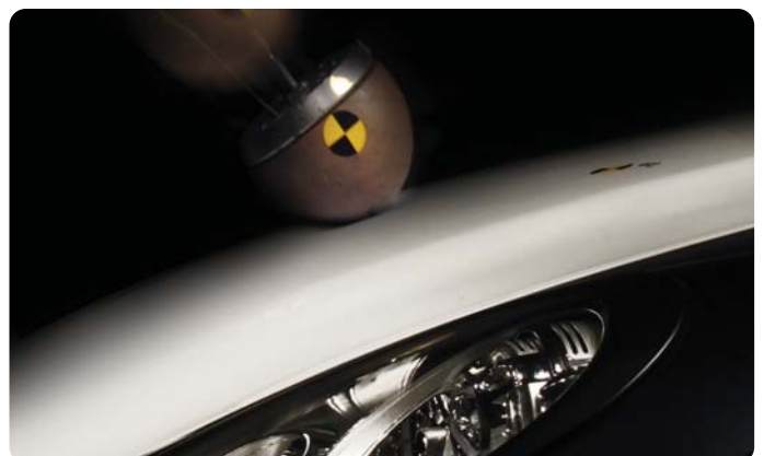
Crashverhalten und Fußgängerschutz: Kopfaufschlagtest einer TECHART Motorhaube Crashworthiness and pedestrian protection: head impact test of a TECHART engine hood
