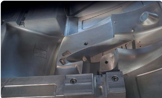
Präzisionsherstellung von PU-RIM Spritzgusswerkzeugen für Qualitäts-Serienfertigung High-precision injection mold tooling enables quality volume production in PU-RIM
